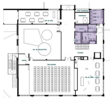
Imatge 17. Espais de serveis i vestidors de la segona planta
