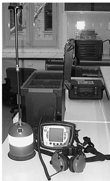
Geòfon electrònic. Equip per identificar punts de fuga en conduccions enterrades.
