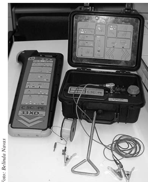
Equip localitzador de línies (cables) i conduccions (canonades) enterrades.
