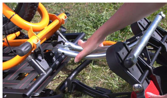
6- Ubicar el pie en las muescas cerrando los dos tubos para facilitar la inserción
