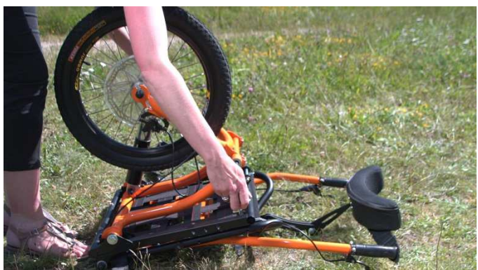
3- Reubicar la clavija en su eje y volver a poner el pasador
