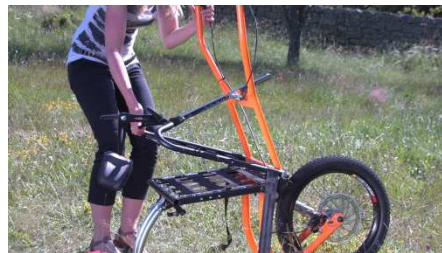
10- Desplegar el respaldo mediante la pequeña empuñadura hasta el contacto con la rueda
