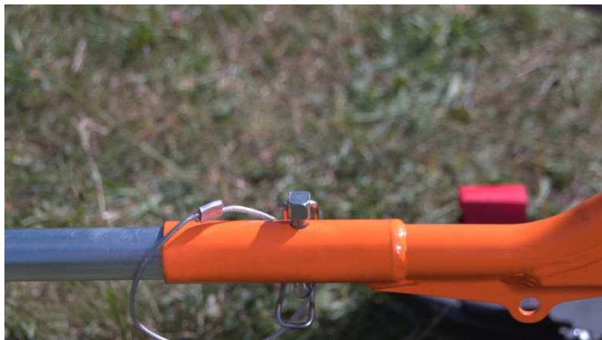
17- Bloquear los brazos con el pasador de seguridad
