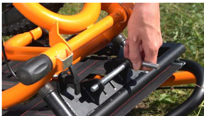
4- Retirar el pasador de seguridad y el eje del compartimiento
