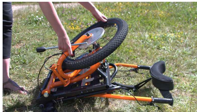
2- Retirar la clavija y el pasador de su emplazamiento y girar la rueda
