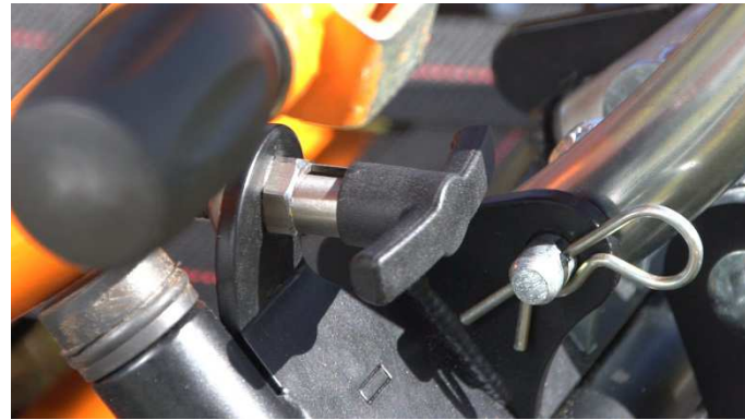
8- Ubicar el perno de anclaje en posición horizontal
