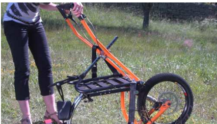
10- Desplegar el respaldo mediante la pequeña empuñadura hasta el contacto con la rueda
