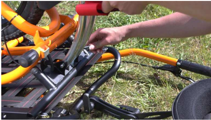
7- Volver a poner el eje en el compartimiento y bloquearlo al interior, luego el pasador
