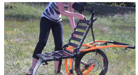
10- Desplegar el respaldo mediante la pequeña empuñadura hasta el contacto con la rueda
