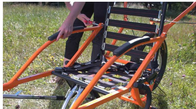
12- Proceder de la misma forma con el asiento y apretar los dos tornillos. Repetir la operación en el segundo brazo.
