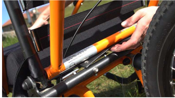
14- Pasar el sistema de anclaje bajo el respaldo y presionar
