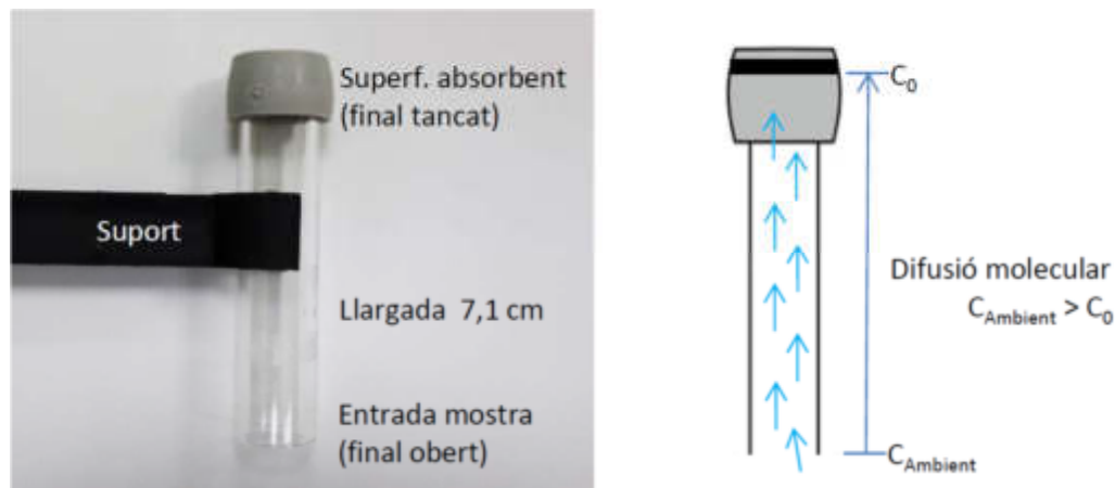
Figura 1: Principi de funcionament dels tubs passius de difusió de \text{NO}_2 de tipus Palmes, on C_{\text{Ambient}} és la concentració de la mostra ambiental i C_0 és la concentració a la superfície de l'absorbent.
